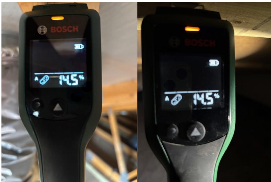
Fuktkvotsmätning i virke på vind
