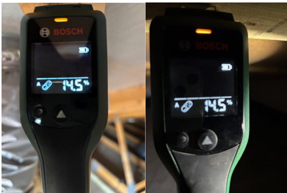
Fuktkvotsmätning i virke på vind
